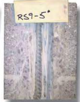
Vista en corte de un relleno de bloques utilizando el Rebar Shaker® de Oztec.
