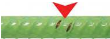
Daño causado por un cabezal para vibrador de acero estándar
